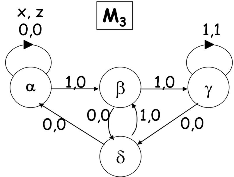
Macchine equivalenti - Sono dette equivalenti macchine sequenziali che presentano uno stesso comportamento impiegando un diverso numero di stati. (Esempio:  $M_1 = M_2 = M_3$ )
